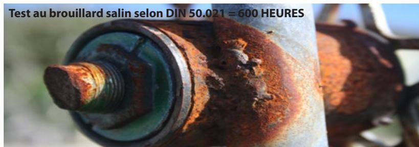
**Description:** Protection primaire de rouille sur toutes les surfaces métalliques brutes. Protection de corrosion secondaire sur les métaux déjà rouillés en formant une couche-barrière imperméable à l'eau et à l'air. Pour obtenir un résultat optimale, les surfaces traitées doivent être exempt de saleté, d'huile, de graisse ou de contaminants similaires. De plus les galettes de rouille et la poussière de rouille doivent être enlevées. Test de corrosion selon DIN 53.210 et DIN 53.209
